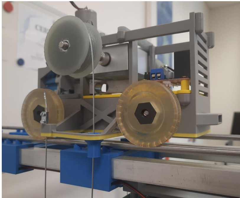
Obr. 2 Konštrukcia mačky žeriava vrátane snímača hmotnosti bremena
