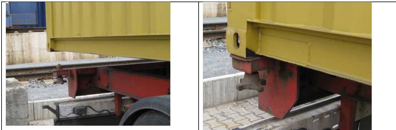
Obr. 4 Příklad nakládání nákladního kontejneru na nákladní automobil, mechanický twistlock jistí polohu
