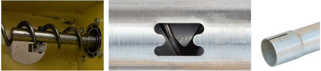
Obr. 6 Detail uchytenia bezosej špirály, nasýpacieho otvoru z dopravníka do krmítka a detail spájacieho hrdla plášťa dopravníka
