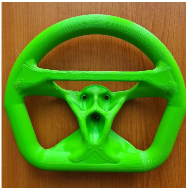
Obr. 7 Optimalizovaný volant vytvorený aditívnou výrobou 75% výplň materiálu ASA
